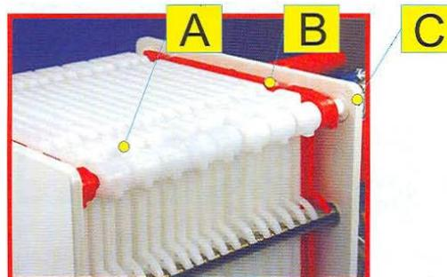
После установки фильтрующих листов, завинтите маховик для фиксации пластин, но не до конца, а лишь до фиксации, затем, полейте их сверху стаканом холодной воды и оставьте на 5-10 мин для набухания, затем снова затените маховики сильнее и снова злейте стаканом воды и оставьте на 5 мин, после чего окончательно затяните маховик.
