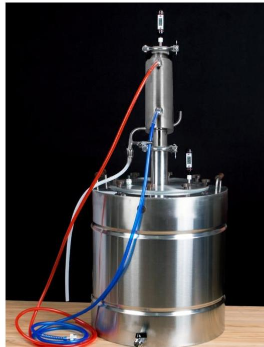
Включите нагрев куба на максимальную мощность. При достижении температуры в кубе 60-70 °C откройте кран с холодной водой и уменьшите нагрев куба. Вытекающая струйка из шланга (красного цвета) должна быть умеренной и иметь температуру порядка- 40-50°C (слегка горячая). При появлении запаха и пара из трубы связи с атмосферой – увеличьте напор холодной воды или уменьшите нагрев куба.
